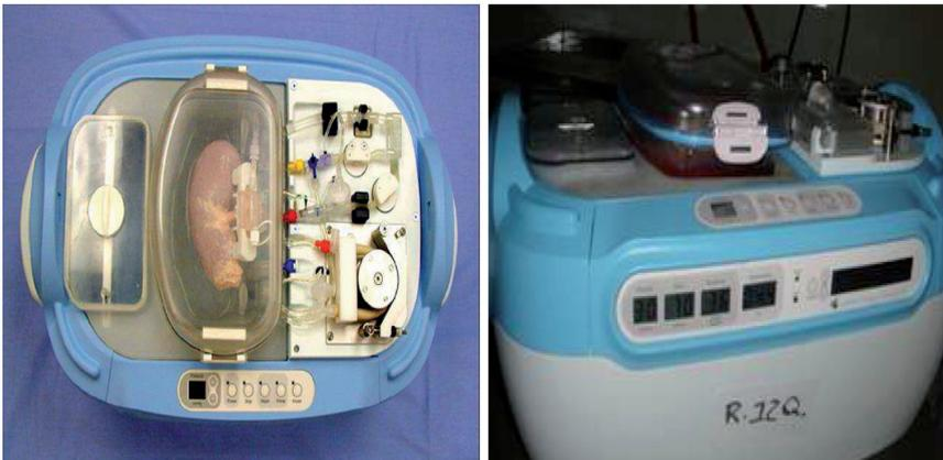
**Figura 17.** Riñón preparado en la máquina de perfusión de flujo pulsátil.
