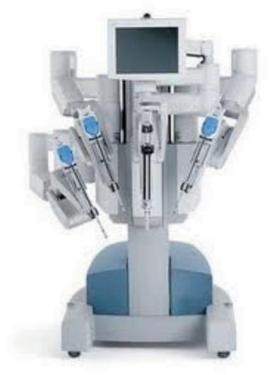
**Figura 3.** Brazos del robot Da Vinci S (modelo mejorado, menos pesado, con pantalla incorporada y movimiento por control remoto).
