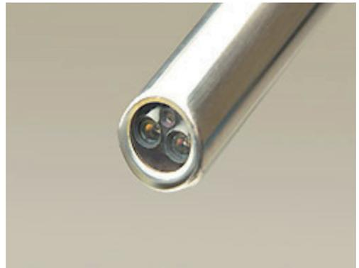
**Figura 13.** La óptica del robot incorpora dos cámaras. Cada una recoge la visión de uno de los ojos. La fusión de ambas imágenes consigue el efecto 3-D.
